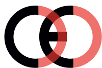
Falsk CE-mærke (for tæt på hinanden)
